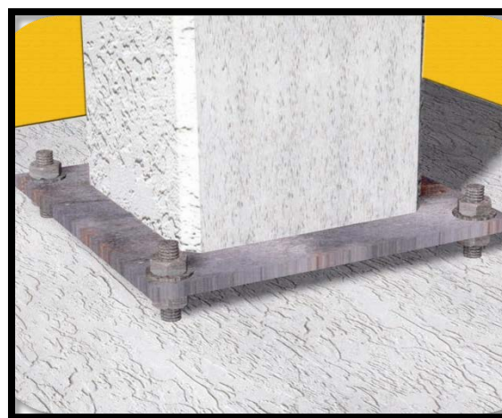
اتصال ستون به فونداسیون در جا با اتصال بیس پلیت
