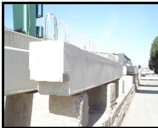
نحوه قرار گیری آرماتورگذاری ژوئن ها جهت پیوستگی بین المانهای مختلف تیر، ستون، سقف و دیوار
