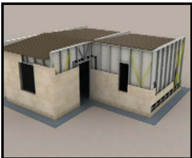
نصب پانل های بیرونی ساتل به صورت فاق و زبانه
