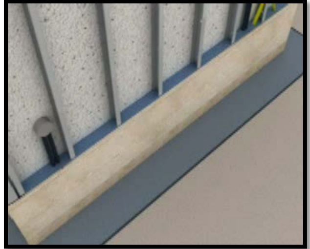
بتن ریزی داخل دیوار همزمان با نصب پانل های ساتل
