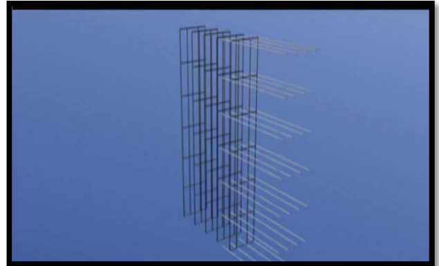
اتصال آرماتورهای پیش بافته افقی و عمودی
